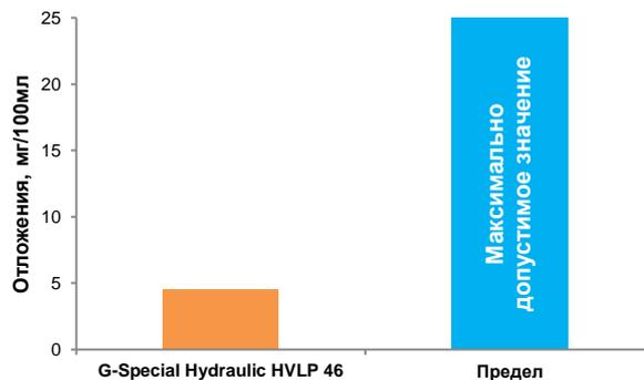
Отличная стойкость к термическому разложению G-Special Hydraulic HVLP-46 позволяет сохранять срок службы гидроприводов оборудования.
